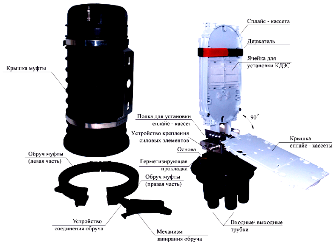
Рисунок 2.8 - Внутрішня будова оптичної муфти
