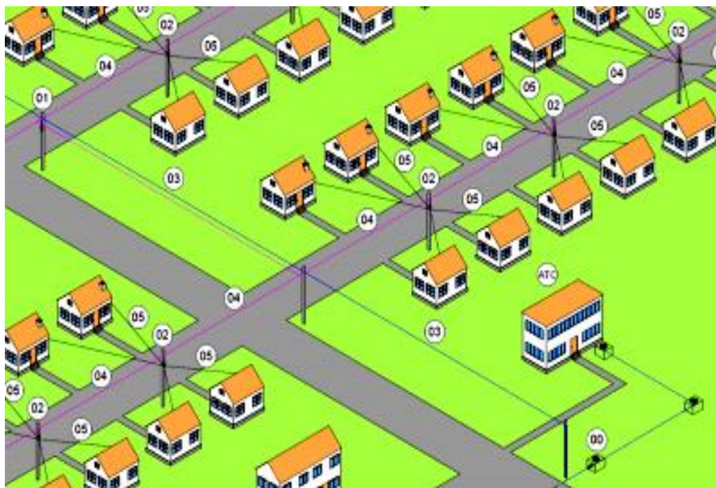
Рисунок 2.13 - Структурна схемна реалізація мережі GPON в районі індивідуального житлового будівництва
