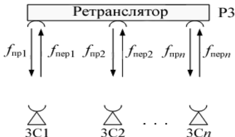
Рисунок 1.2 – Організація супутникового зв'язку за методом «кожний з кожним»
