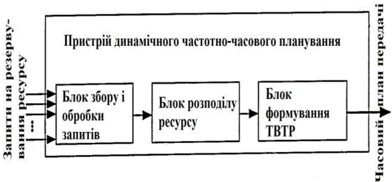
Рисунок 1.11 – Склад пристрою динамічного частотно-часового планування
