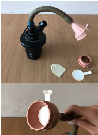
Рис. 1 – Загальний вигляд аспіратора проб пилу (фрагмент зверху) та патрона з фільтром
