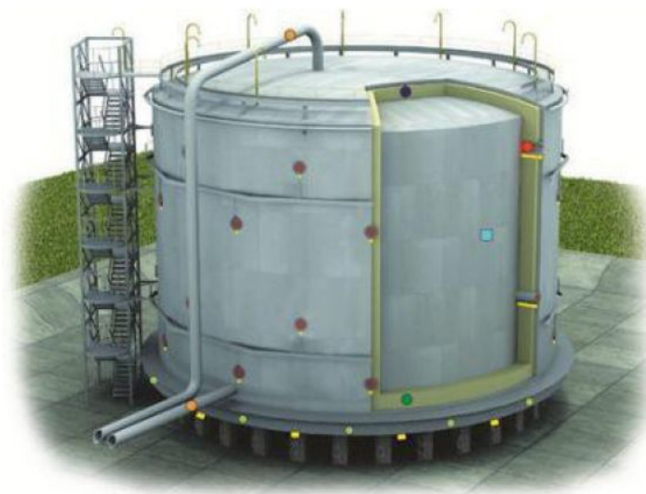
Рис. 4.53. Двостінний металевий резервуар з пінополіуретановою теплоізоляцією
