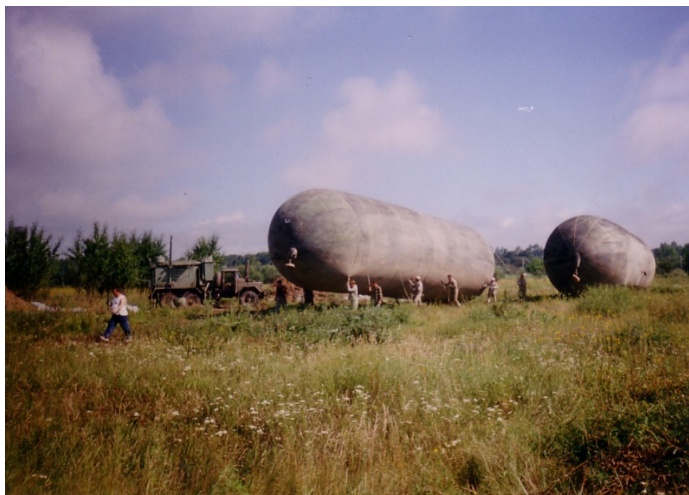
Рис. 4.27. Наповнення м'яких газгольдерів воднем від газогенератора
