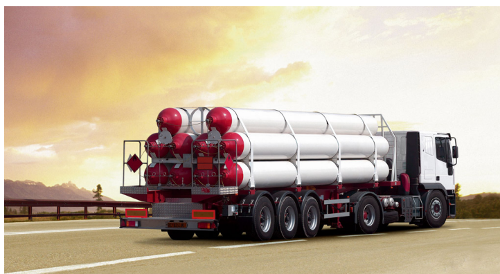
Рис. 4.34. Газовоз з балонами на основі труб магістрального газопроводу
