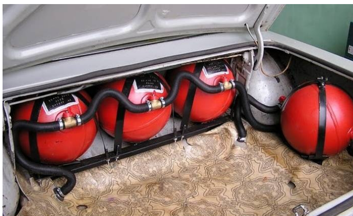
Рис. 4.29. Титанові балони в багажнику легкового автомобіля, переведеного на метан
