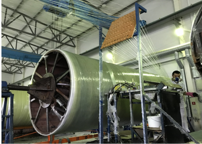
Рис. 2.69. Навивання склотканини на матрицю резервуара з одночасним нанесенням поліефірних смол
