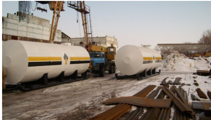
Рис. 2.48. Пересувний горизонтальний циліндричний резервуар (на санчатах)
