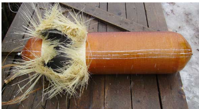
Рис. 4.80. Композитний балон після вибуху
