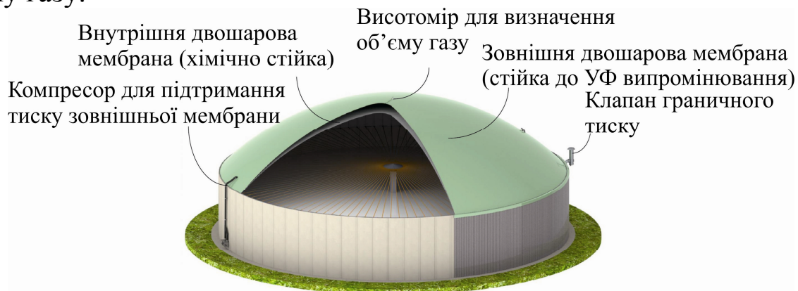
Рис. 4.25. Двокамерний агрегатований газгольдер постійного тиску з метантенком
