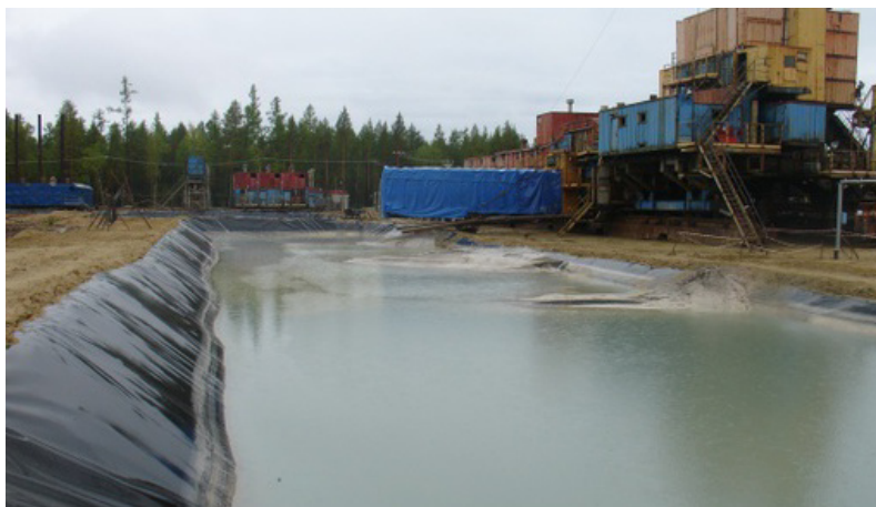
Рис. 2.73. Зберігання нафти у котловані з полімерним вкладишем
