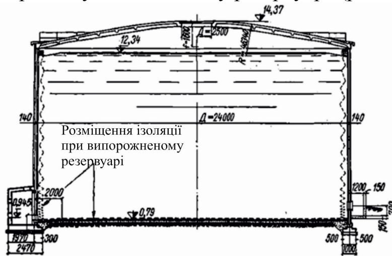
Рис. 2.59. Наземний залізобетонний збірний резервуар з гофрованою еластичною ізоляцією
