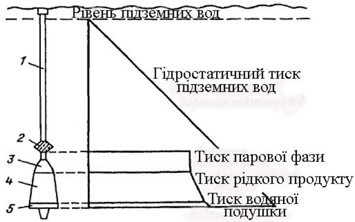
Рис. 3.4. Принципова схема герметизації резервуара з притоком підземних вод у виробку-місткість: 1 – ствол; 2 – перемичка; 3 – парова фаза; 4 – рідкі вуглеводні у виробці-місткості; 5 – вода
