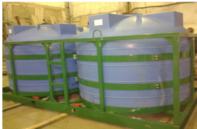
Рис. 2.66. Варіант обв'язки пластикових місткостей
