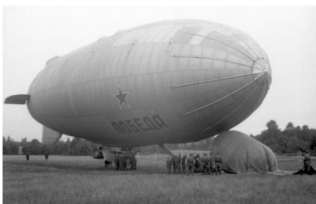
Рис. 4.3. Заправка м'якого газгольдера від дирижабля-газовоза
