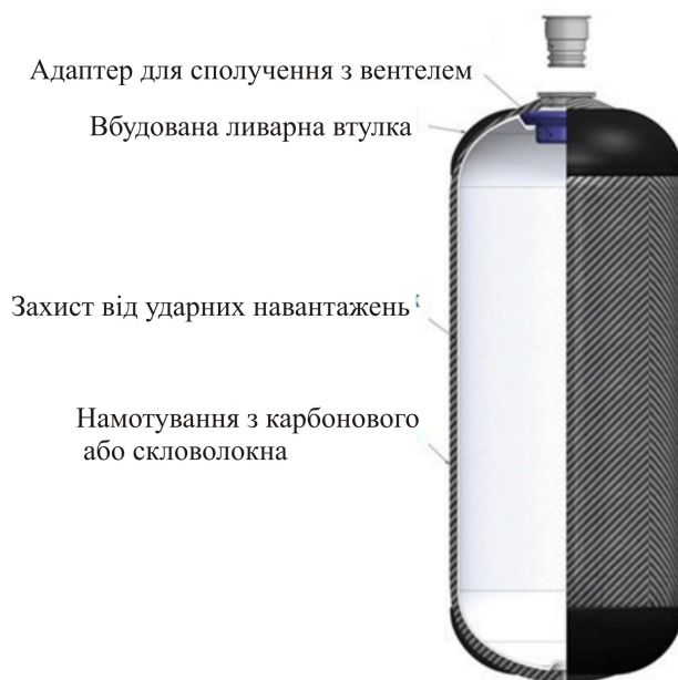
Рис. 4.79. Конструкція композитного балона для зрідженого пропан-бутану
