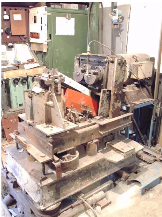
Рисунок 2 – Вибрационная щековая дробилка с наклонной камерой дробления
