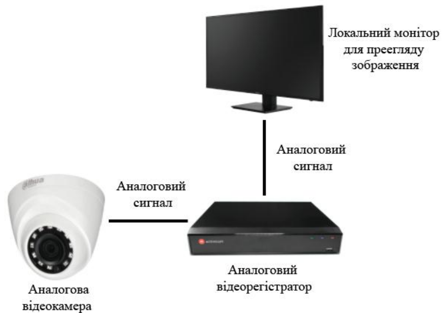
Рисунок 1.7 - схема побудови аналогового відеоспостереження
