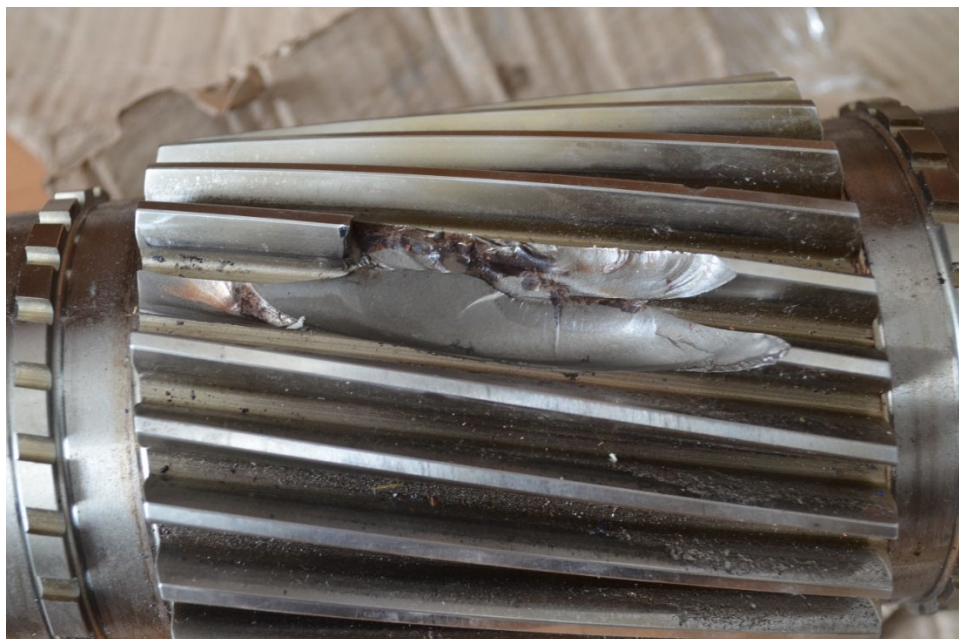
Рис.2. – Осколок зуба вала-шестерні редуктора турбогенератора типу SST-110
