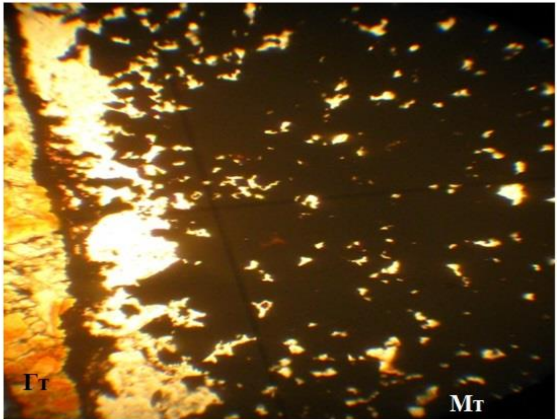
Рисунок 3.5- Карбонатизований залізистий кварцит з прожилками гетиту. Шліф, нік II, зб.90
