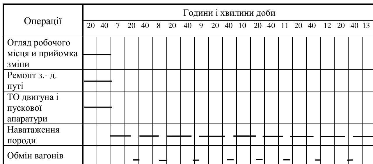
Рис. 3.2. Приклад змінного лінійного часового графіка виймально-навантажувального процесу у вибої
