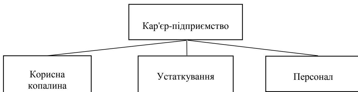
Рис. 1.1. Об'єкти планування та організації, що забезпечують реалізацію процесів відкритих гірничих роботи : — — зв'язки приналежності
