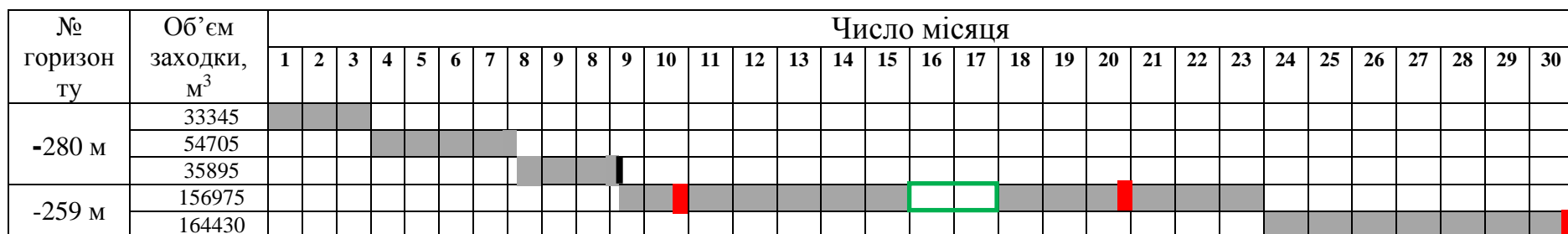
Рис. 1.2. Лінійний часовий графік гірничих робіт на 2-й місяць: час на технічне обслуговування і поточний ремонт екскаватора; відгін екскаватора, масовий вибух и повернення на робоче місце, перегін екскаватора в інший вибій
