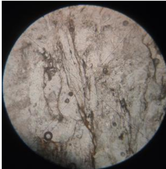
Рисунок 3.3 – Особливості динамометаморфічних структур порід діловецької світи Верхнього Рифею, струмок Лихий. Збільшення \times 64 , ніколі не схрещені
