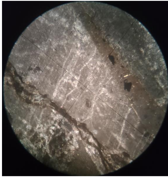
Рисунок 3.24 – Мінералого-структурні особливості порід четвертої проби з кам'янопотоцької світи. Збільшення \times 64 , ніколи схрещені
