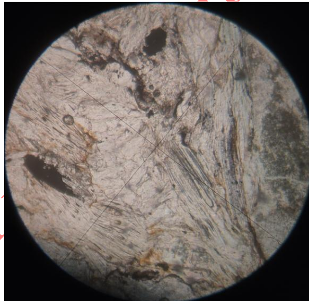
Рисунок 3.7 – Особливості динамометаморфічних структур порід діловецької світи Верхнього Рифею, струмок Лихий. Збільшення х64, ніколі не схрещені
