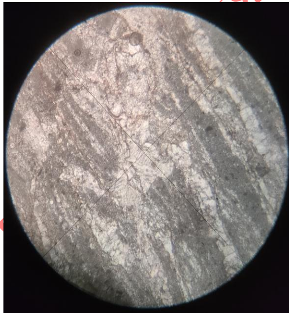
Рисунок 3.27 – Мінералого-структурні особливості порід четвертої проби з кам'янопотоцької світи. Збільшення х64, ніколі не схрещені
