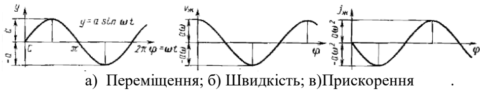
Рис.1.1 – Діаграма параметрів жолоба вібраційного конвеєра при гармонічних коливань
