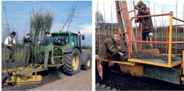
а б Фото 8. Саджалки моделі PL-40: а — садіння саджанців дерев; б — суміщення операцій устанавлення посадкових кілків та садіння саджанців
