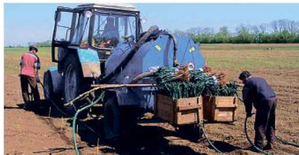
Фото 4. Гідробур ГБ-35/28 під час садіння
