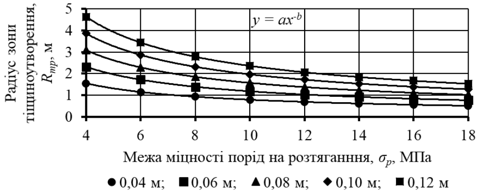
Рисунок 4 – Графік зміни радіусу зони тріщиноутворення від міцності порід на розтягання та діаметру зарядної порожнини при тиску продуктів вибуху 1500 МПа
