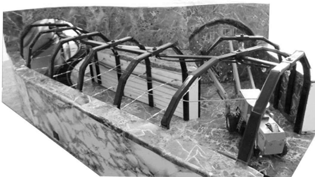
Рис. 1. Макет «Фрагмент проведення горизонтальних гірничих виробок за допомогою бурової установки «Boomer» фірми Atlas Copco (Швеція)»
