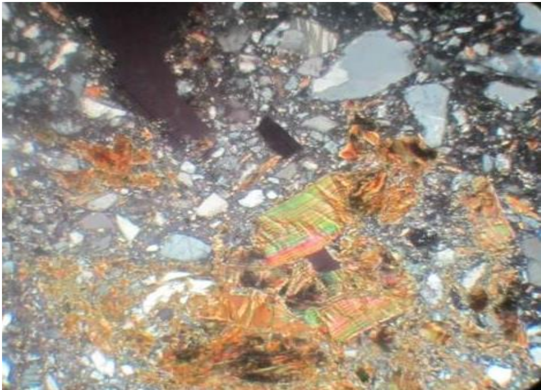
Рисунок 3.12 – Розвиток біотиту пізньої генерації в катаклазованій та грейзенізованій породі зони рудопрояву. Шліф, нік+, зб.90
