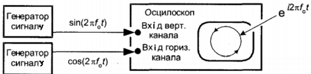
Рис. 7.5. Візуалізація квадратурного сигналу за допомогою осцилоскопа
