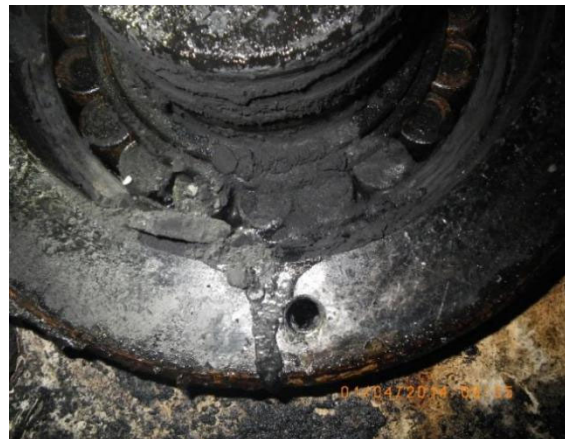
Рисунок 2 - Типові руйнування підшипників скребкового конвеєру гіпербарфільтру
