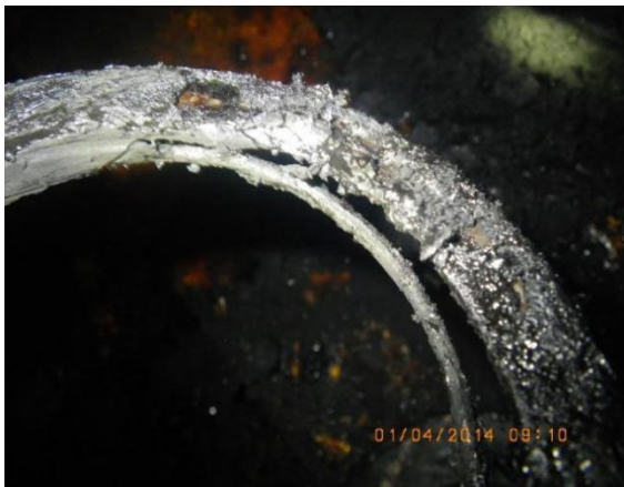
Рисунок 2 - Типові руйнування підшипників скребкового конвеєру гіпербарфільтру
