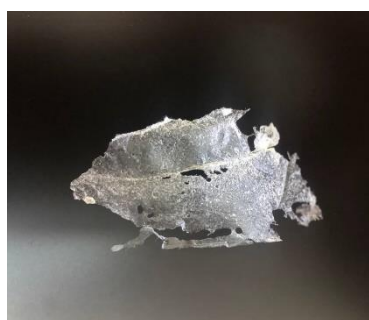
Рис. 1. Композиційний полімер на основі кальцій альгінату, агар-агар, крохмалю відповідно 3:2:1
