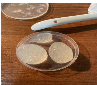
Рис. 1. Композиційний полімер на основі кальцій альгінату, агар-агар, крохмалю відповідно 3:2:1
