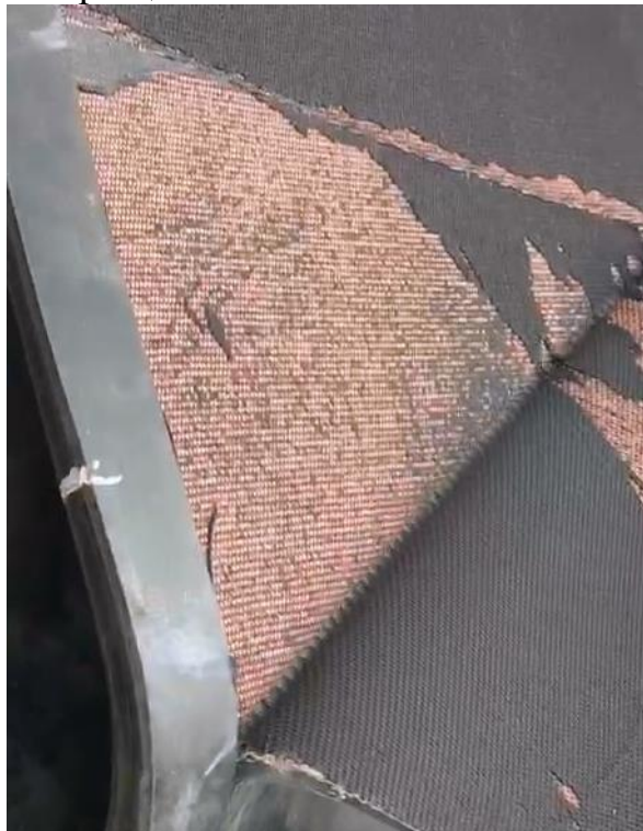
Рис. 2 Зняття верхньої обкладки відпрацьованої стрічки
