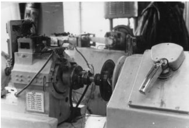
Рис. 1.9. Зовнішній вигляд (ліворуч) та схема розташування (праворуч) об'єднаного пульту керування та вимірювання триботехнічних параметрів на машинах тертя МФТ-1 та МДП-1
