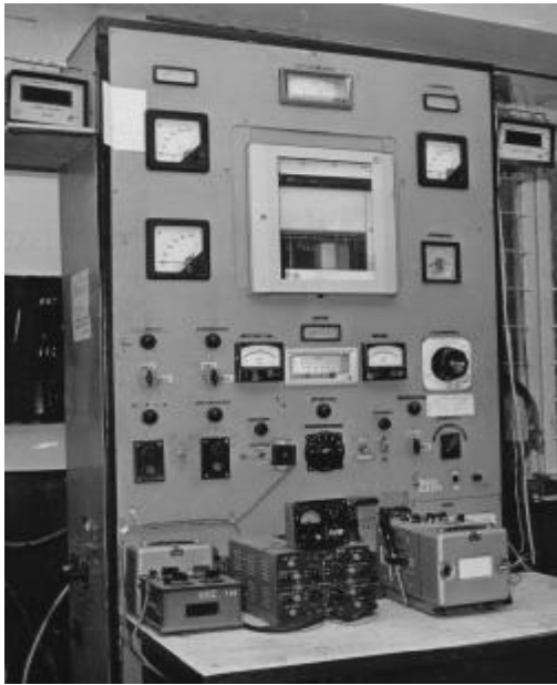
Рис. 1.9. Зовнішній вигляд (ліворуч) та схема розташування (праворуч) об'єднаного пульту керування та вимірювання триботехнічних параметрів на машинах тертя МФТ-1 та МДП-1
