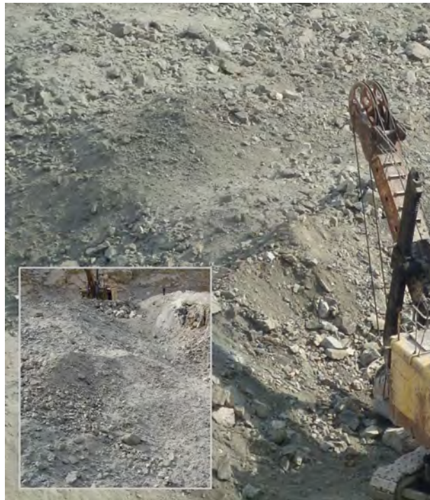
Рис. 3.19. Результати масового вибуху на Чаплінському кар'єрі
