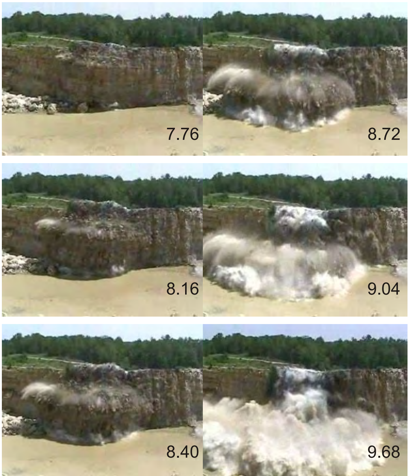
Рис. 3.30. Кінограма вибуху вертикальних свердловинних зарядів з використанням неелектричної системи ініціювання
