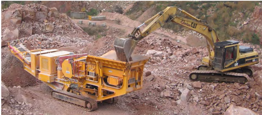
Рис. 2.18. Загальний вигляд СДА, виготовленого на базі щоквої дробарки, у вибої гранітного кар'єру
