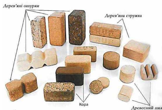
Рисунок 1.1 - Види форм та конфігурацій паливних брикетів з деревинної сировини
