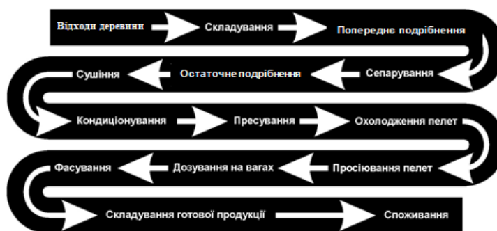
Рисунок 1.2 – Технологічна послідовність виготовлення пелет з відходів деревини
