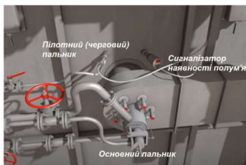
Рисунок 1.4 – Основний пальник з сигналізатором та пілотним пальником
