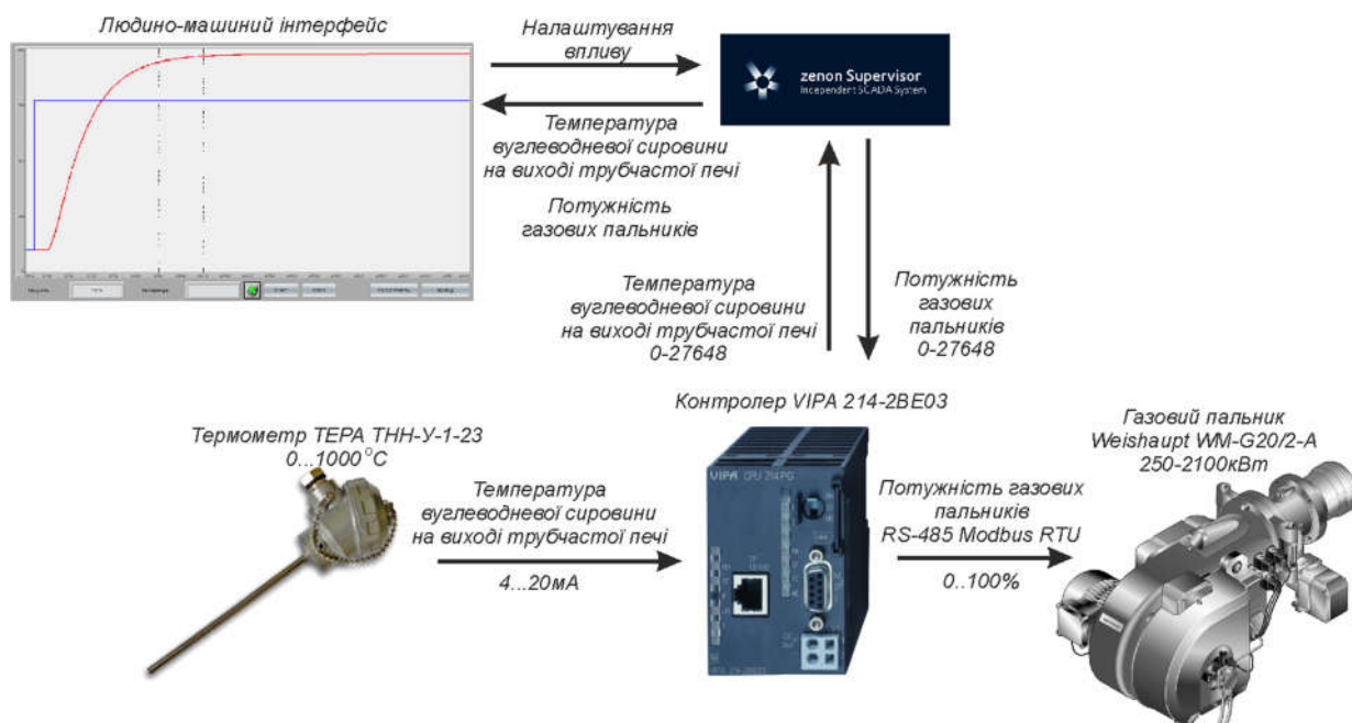
Рисунок 3.1 – Структурна схема інформаційних потоків дослідницької системи
