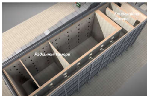
Рисунок 1.3 – Конвекційна та радіантні камери
