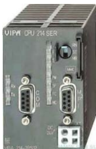
Рисунок 2.7 – Програмований логічний контролер VIPA 214-2BS33
