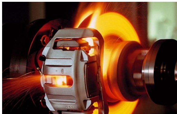
Рисунок 1.15 – Тестування гальмівної колодки
