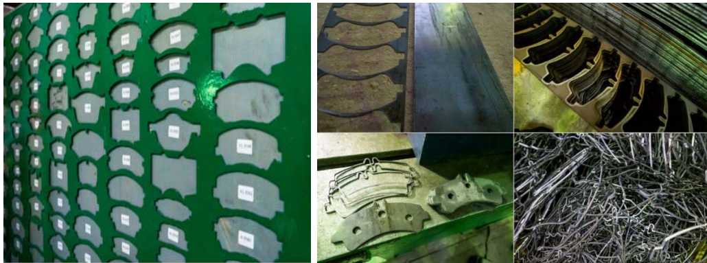
Рисунок 1.5 – Основа гальмівної колодки - каркасу з металу
