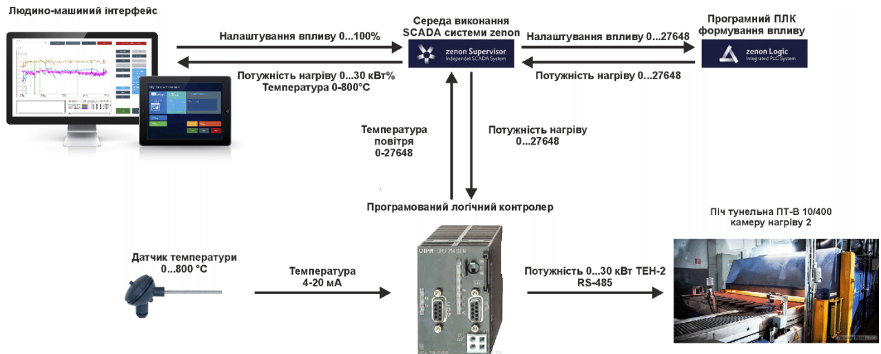
Рисунок 3.1 – Структурна схема інформаційних потоків дослідницької системи
