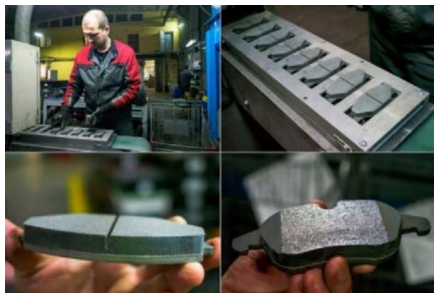
Рисунок 1.12 – Механічна обробка колодок
