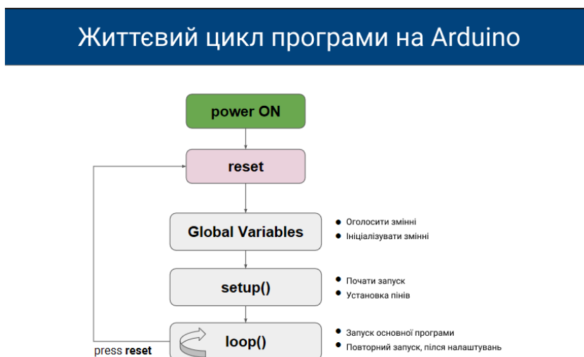
Рис. 1.3. Модель життєвого циклу для програм Arduino
