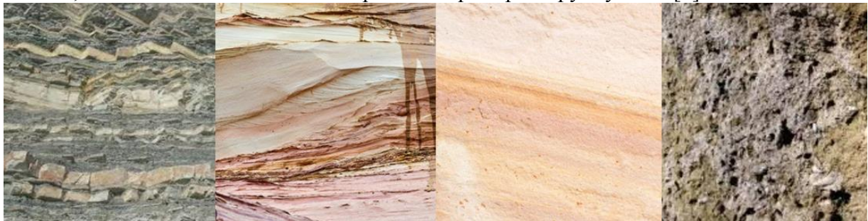
Рисунок 1. – Гірські породи, які є типовими для геологічних розрізів нафтогазових родовищ (у порядку слідування: аргіліт, алевроліт, пісковик, вапняк)
