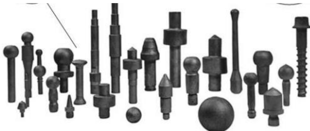
Рисунок 2 - Форми деталей, що виробляють з застосуванням поперечно - клинної прокатки [1]
