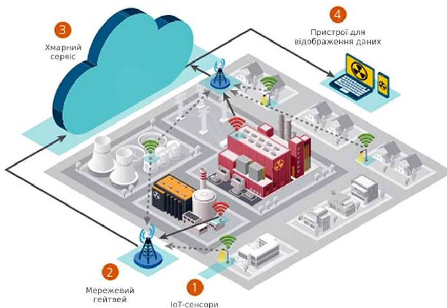
Рисунок 1 – Приклад типової організації наземної IoT-технології радіаційного контролю [5]
