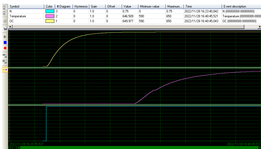
Рисунок 4.10 – Результат моделювання роботи об'єкту керування
