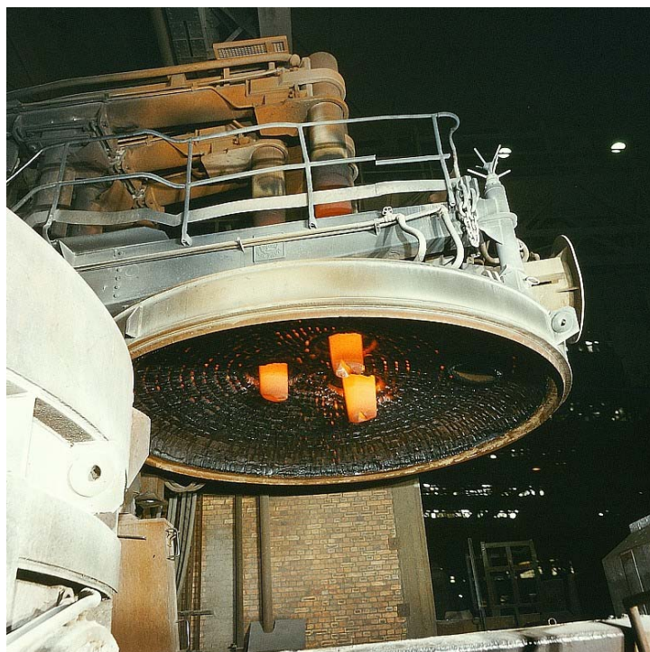
Рисунок 1.3 - Кришка дугової печі (видно три нагріті електроди)
