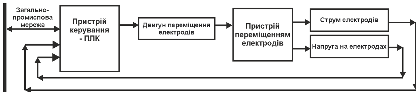
Рисунок 2.1 – Структурна схема системи керування
