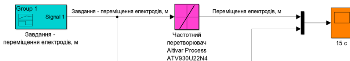
Рисунок 3.18 – Схема обмеження швидкості переміщення електродів
