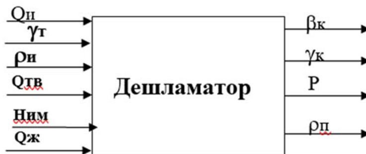
Рисунок 1.5 – Структурна схема дешламатора як об'єкта керування
