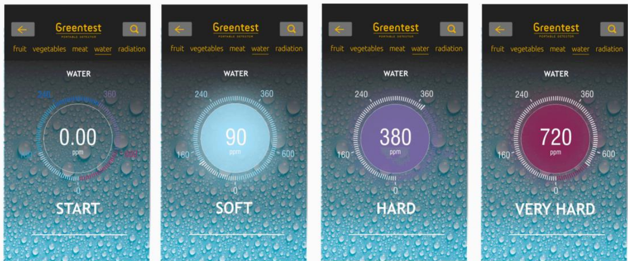
Рис. 7. Приклад відображення результатів вимірювання жорсткості води у додатку Greentest
