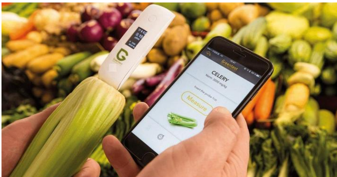
Рис. 12. Проведення вимірювання концентрації нітратів за допомогою приладу Greentest mini
