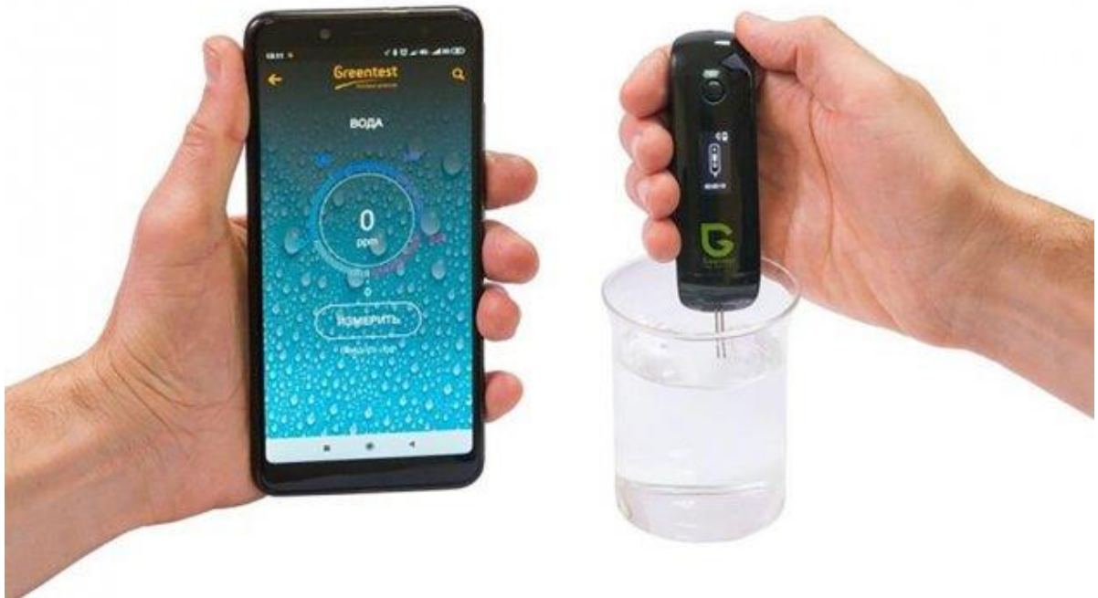
Рис. 14. Проведення вимірювання жорсткості води за допомогою приладу Greentest mini
