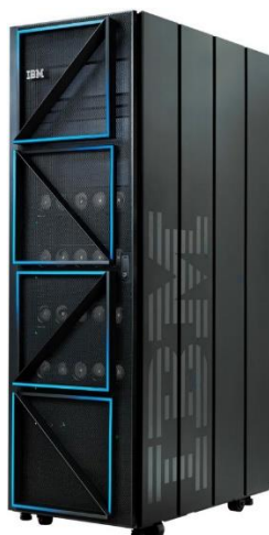
Рисунок 1.5 – Сервер IBM Power 1080. Конфігурація з 4 вимірними вузлами
