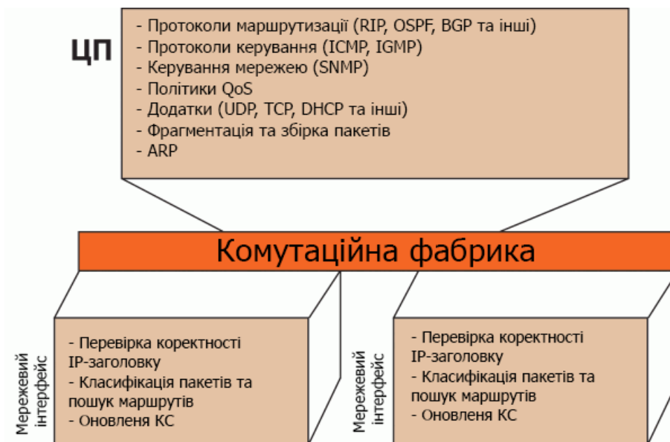
Рисунок 2.4 – Приклад функціонального поділу в розподіленій архітектурі
