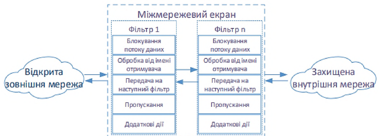
Рисунок 1.9 – Структура міжмережевого екрану
