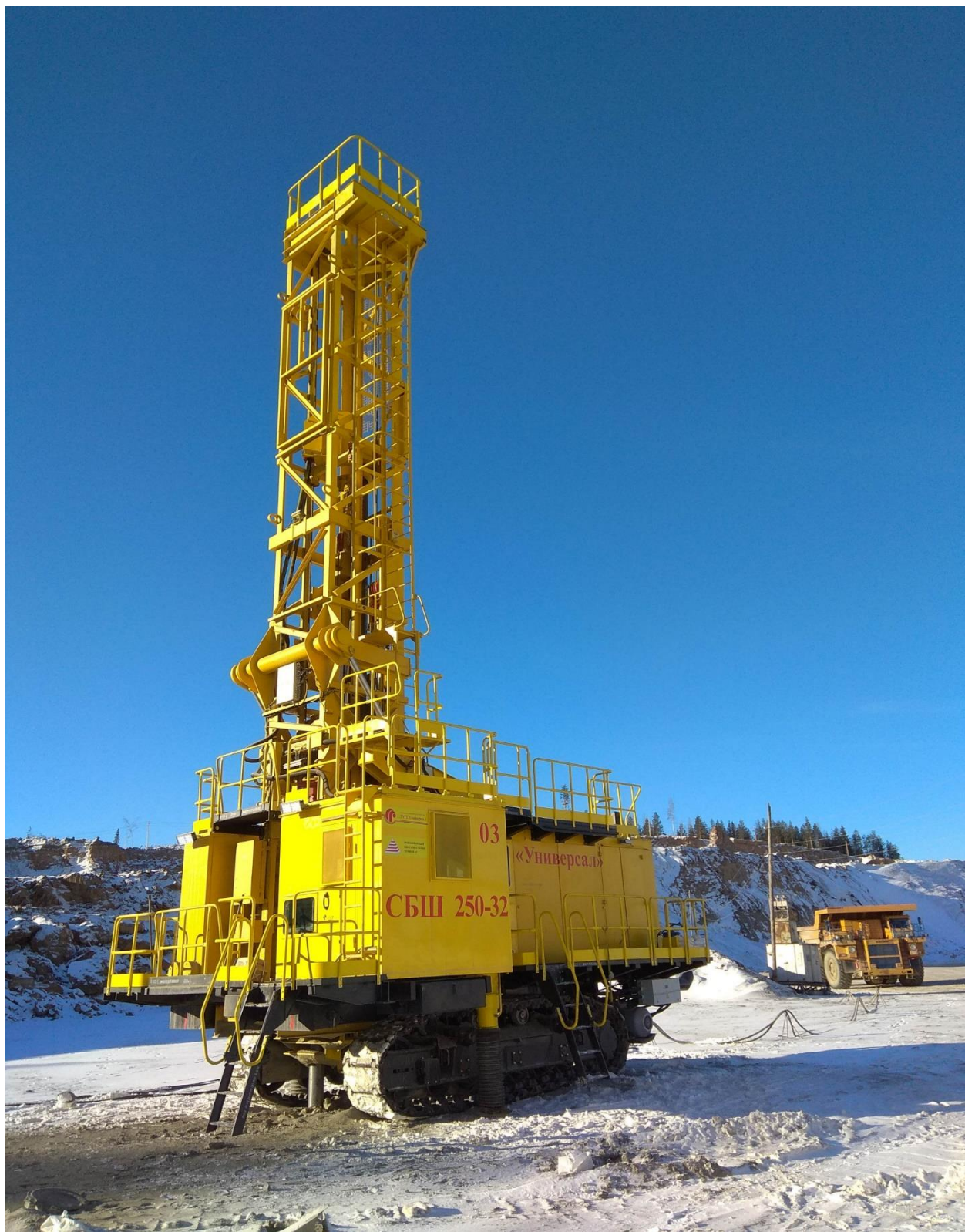
(Рис2.2) Буровой станок СБШ-250
