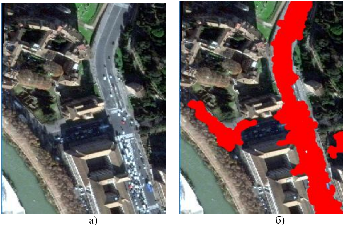
Рис. 2. Фрагменти зображень: а) первинне мультиспектральне зображення; б) результат розпізнавання доріг після обробки
