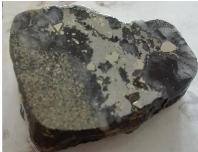
Рисунок 3.2 - Аншліф гематит-магнетитового залізистого кварциту з метакристалами піриту та вкрапленістю халькопіриту та піротину.
