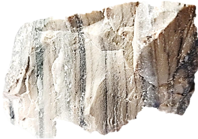
Рисунок 4.5 - Кварцевий сидеритоліт шаруватої текстури, яка обумовлена чергуванням кварцевих (сіре) та кварц-сидероплезитових шарів, жовтуваті шари – сидероплезитового складу
