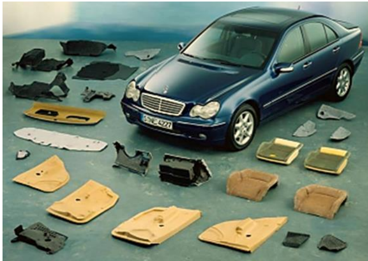
Рис. 5.1 – Використання ПКМ у деталях автомобіля
