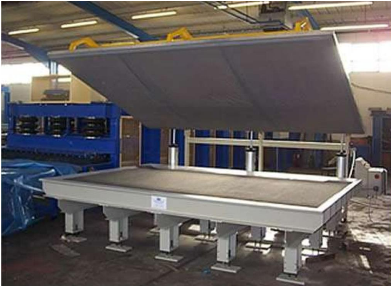
Рис. 4.2 – Прес для виготовлення ПКМ
