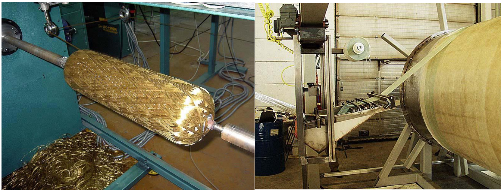
Рис. 4.6 – Формування ПКМ методом намотування
