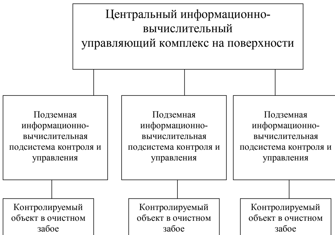
Рис. 3.5. Радиальная структурная схема децентрализованной системы управления очистного забоя
