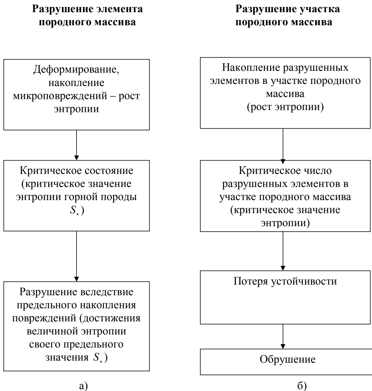
Рис. 6.17. Разрушение элемента горной породы (а) и участка массива, содержащего очистную выработку (б)
