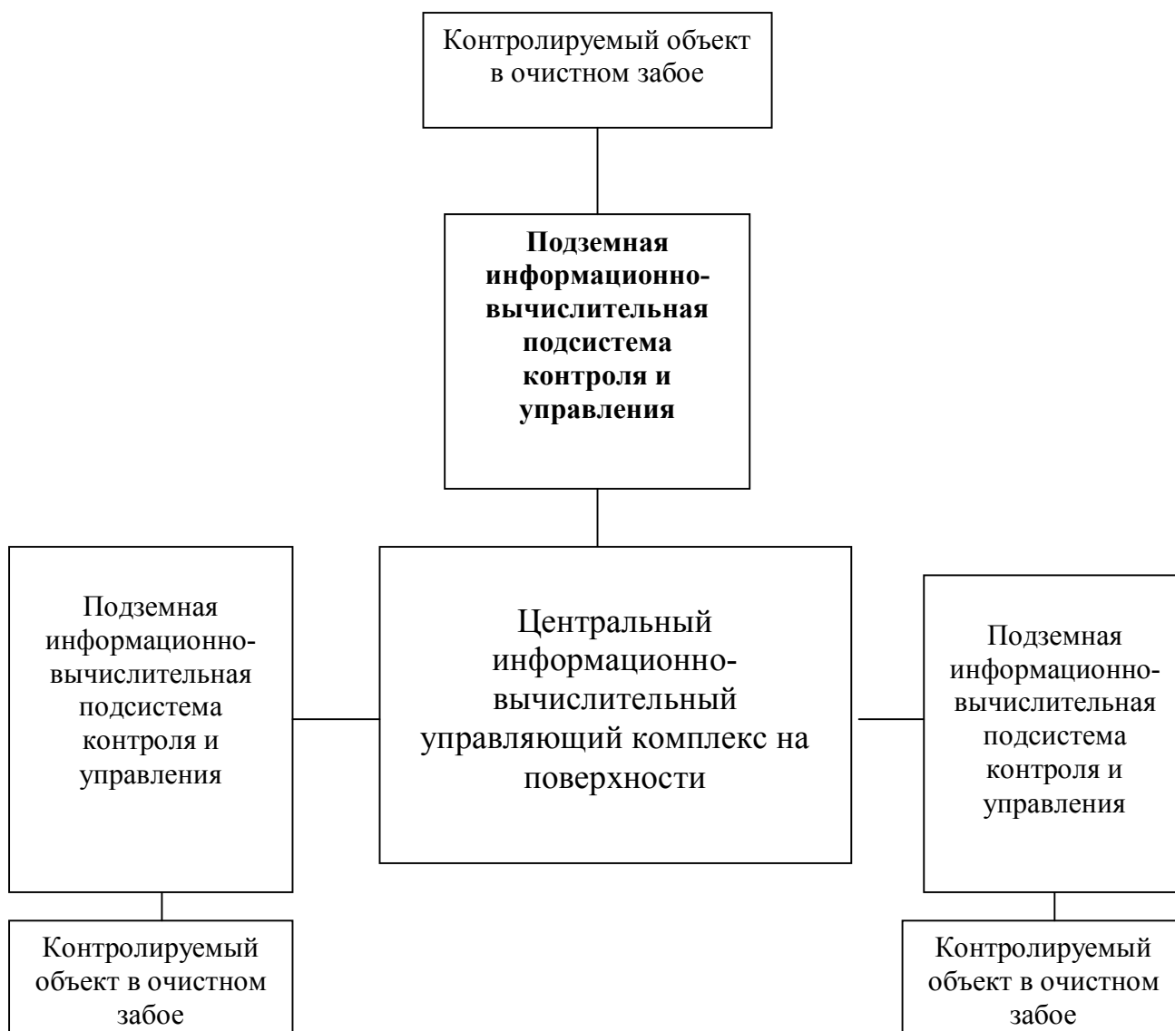
Рис. 3.6. Кольцевая структурная схема децентрализованной системы управления очистном забое
