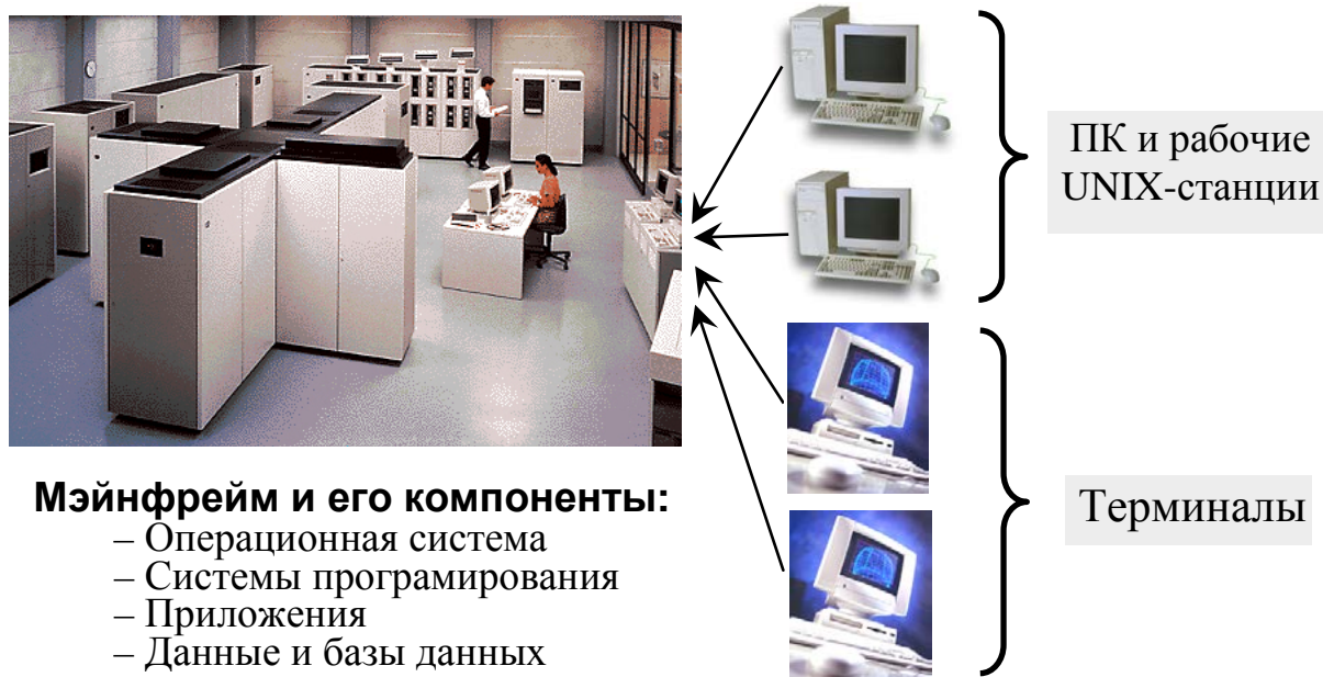
Рис. 6.15. Архитектура мэйнфреймов и работы с ним
