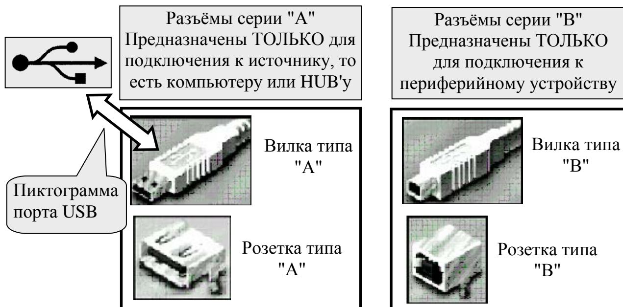
Рис. 4.23. Пиктограмма обозначения и разъёмы (вилки и розетки) последовательного порта USB
