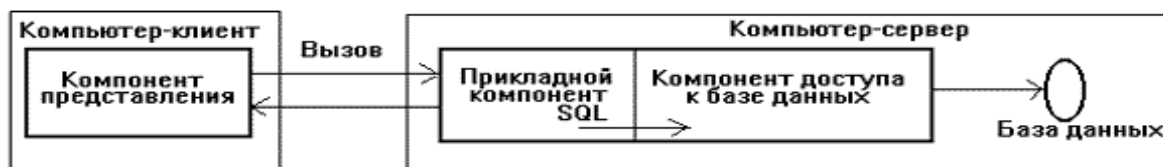
Рис. 6.17. Модель клиент/серверной архитектуры с сервером баз данных
