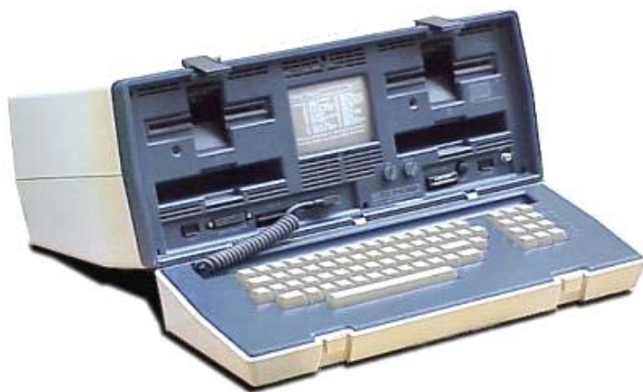
Рис. 9. Один из первых персональных компьютеров, созданный и выпускаемый в виде чемодана компанией Osborne Computers (США). Вес в собранном виде 10 кг (1981 г.).
