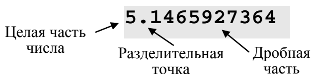
Рис. 8.27 Компоненты представления числа с фиксированной точкой
