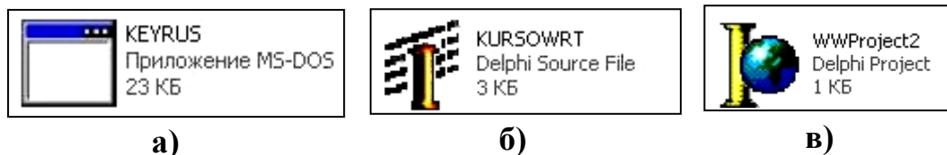
Рис. 4.20. Иконки (пиктограммы) файлов в ОС Windows XP: а) драйвера кириллизатора KEYRUS с расширением .COM, б) текста Турбо Паскаль KURSOWRT с расширением .PAS в) текста консольного приложения WWProject2 с расширением .DPR
