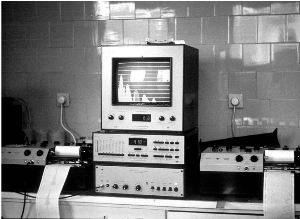
Рис. 2.2. Аппаратурный комплекс фирмы «Брюль – Кьер» для обработки данных, записанных на магнитограф, при работе в режиме спектрального анализа вертикальных колебаний клетки
