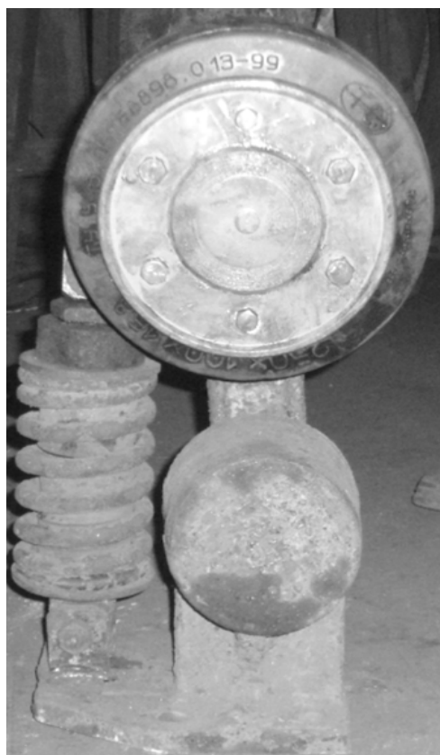
Рис. 6.38. Роликовая двухрычажная направляющая: a) стандартная; б) модернизированная
