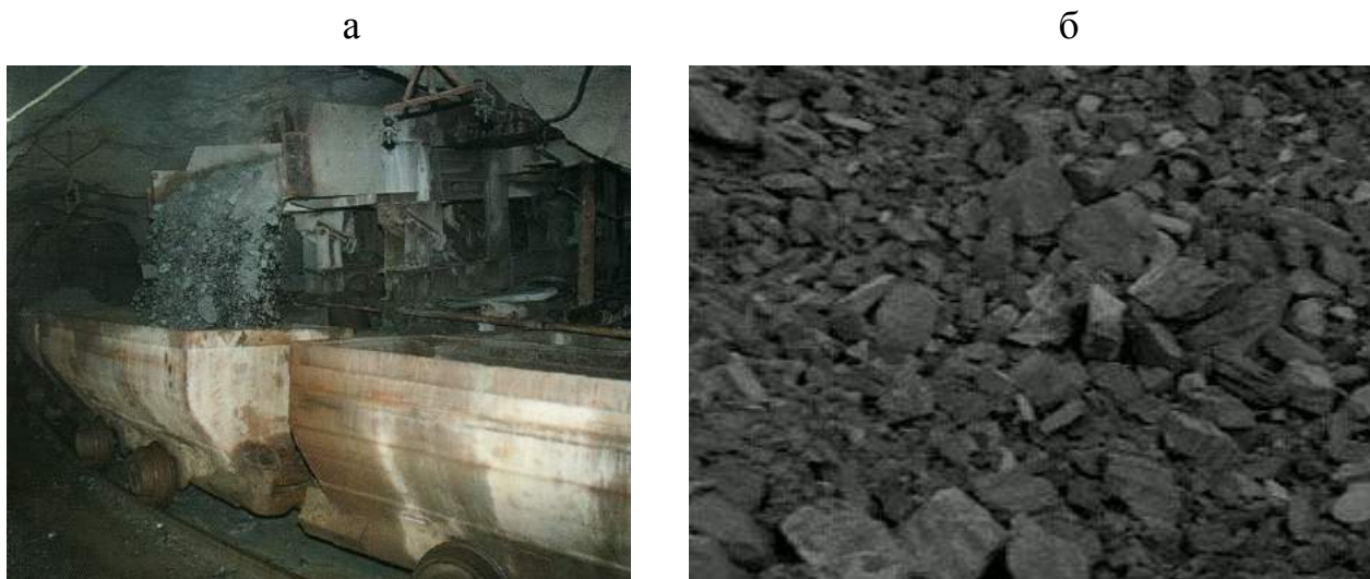
Рис. 2.12. Выпуск руды из камеры на откаточном горизонте 550 м(а) и внешний вид горной массы в вагонетке (б)
