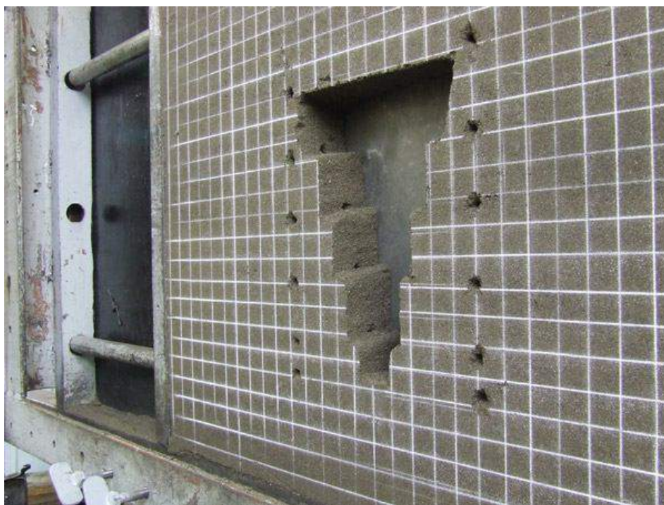
Рис. 4.4. Модель камеры при 70% отработки запасов до нагружения на глубинах 460 – 550 м шахты «Смолинская» ГП «ВостГОК»
