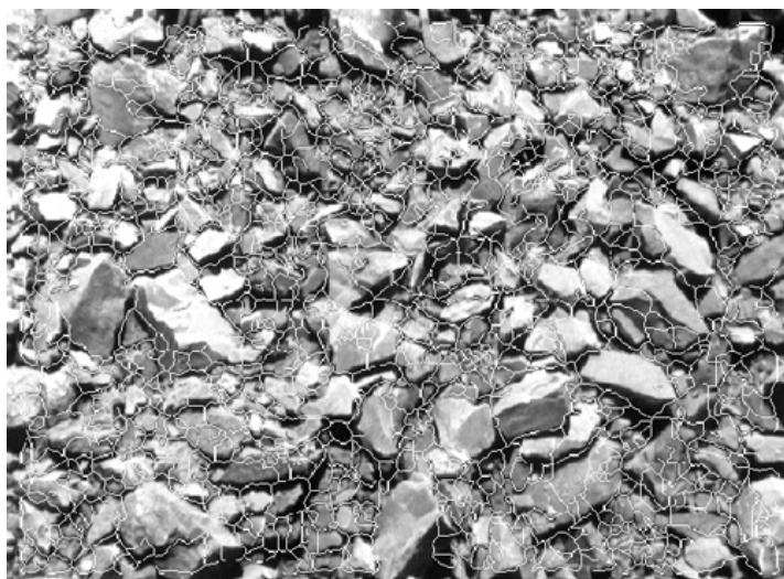
Рис. 2.14. Пример выхода промежуточной информации для дальнейшей обработки с помощью программного продукта «Wipfrag»
