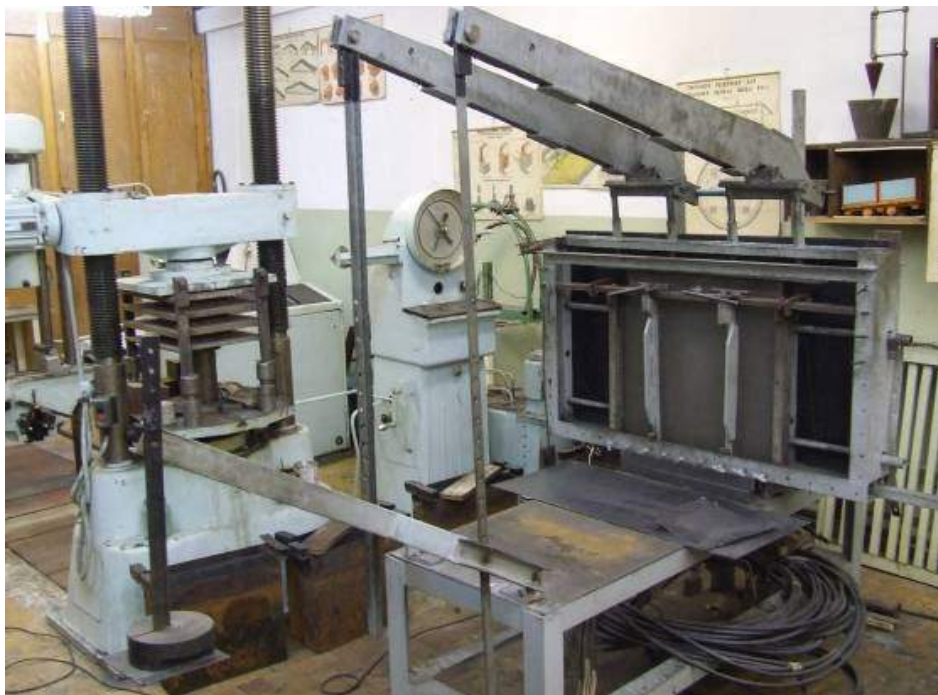
Рис. 2.11. Общий вид плоского стенда для моделирования на эквивалентных материалах
