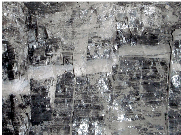
Рис. 4. Система техногенных трещин в 854-й лаве
