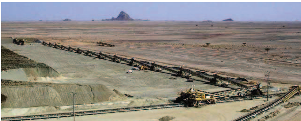
Рис. 2. Схема использования короткозвенных мобильных конвейеров
