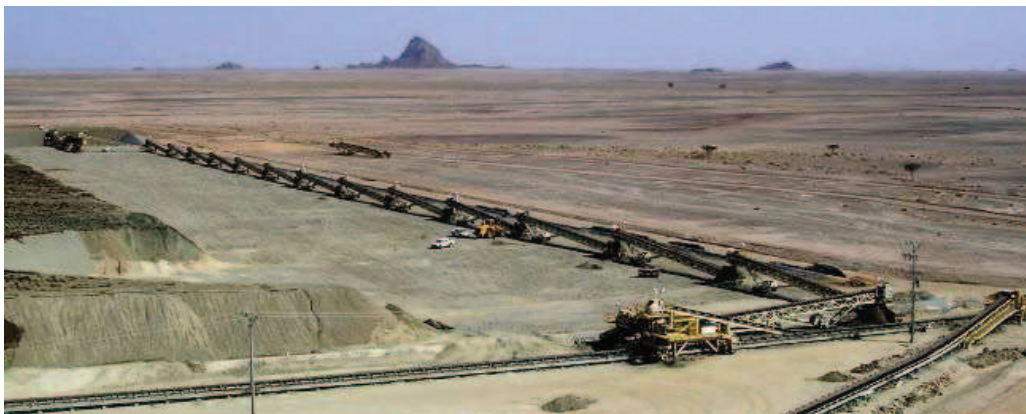
Рис. 2. Схема использования короткозвенных мобильных конвейеров
