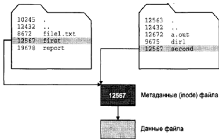
Рис. Б.1. Жесткая связь имен с данными файла [4]
