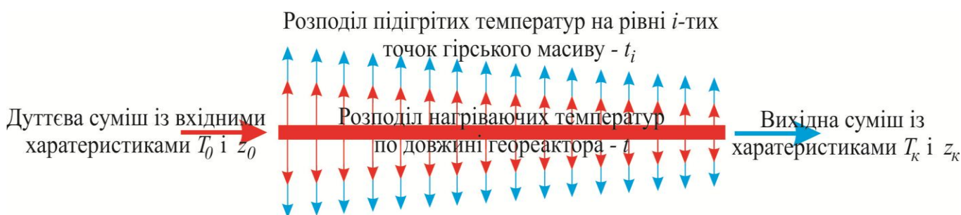
Рис. 5. Розрахункова схема теплообміну в межах зони впливу підвищених температур від геореактора
