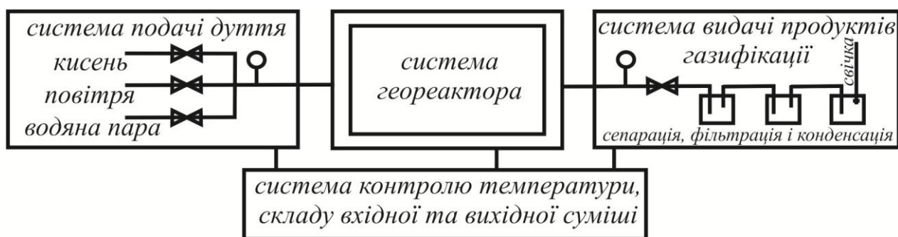
Рис. 4. Технологічна схема стендової установки підземної газифікації вугілля
