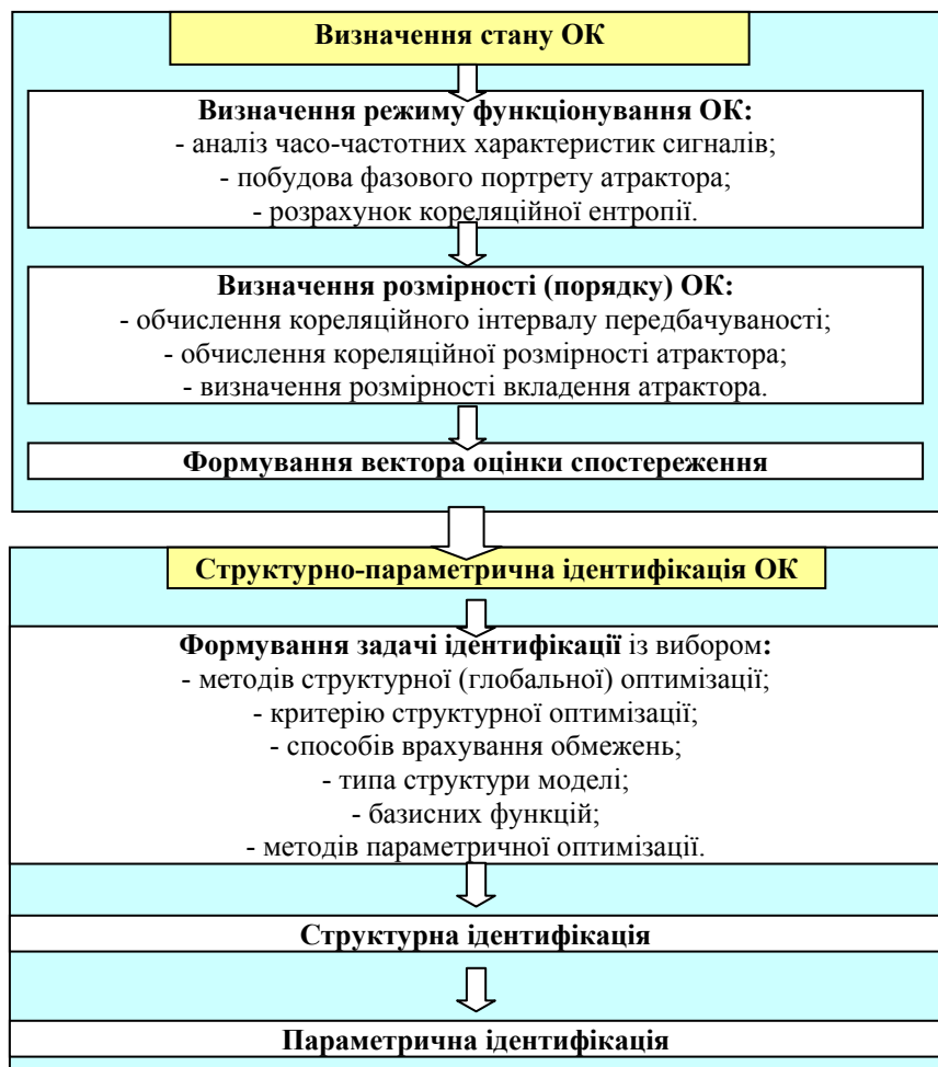
Рис. 4.5. Структурна схема ідентифікації нелінійних процесів дроблення і здрібнювання
