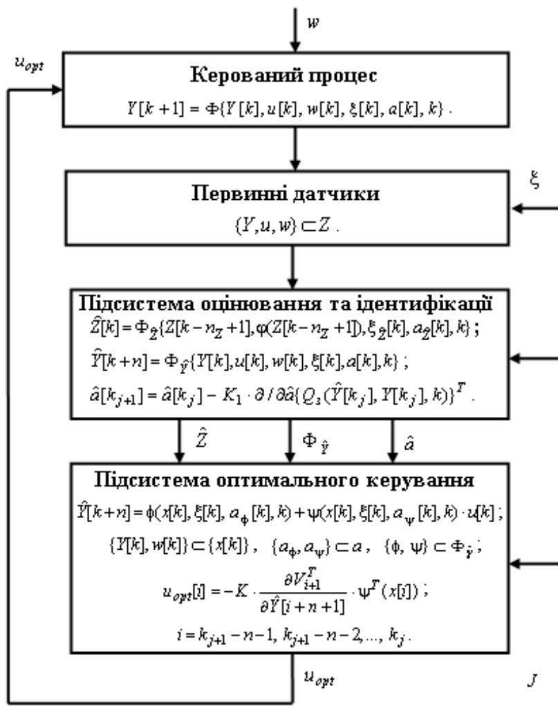
Рис. 5.6. Структура АСОК за ФУР із прогнозуючою моделлю
