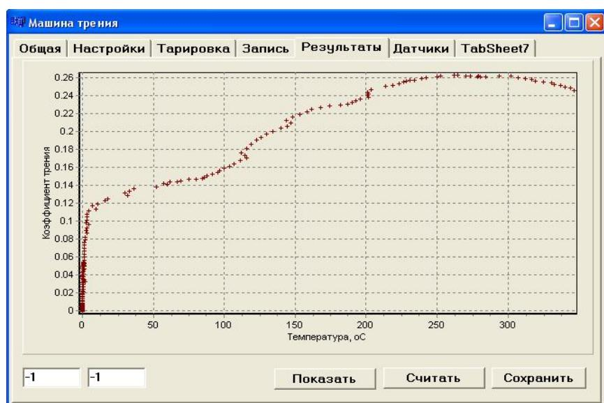
Рисунок 5.14 – Программа «FrictionMachine» (закладка «Результаты»)
